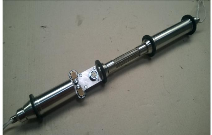
ABM 40 Configuré pour un tuyau de 40 mm. I. D.
