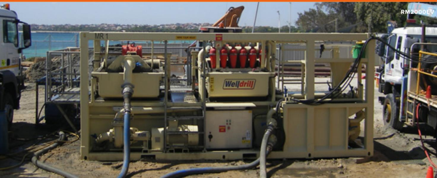
En cas de rendement suffisant ou lors du forage pilote, pas besoin de grande capacité de mélange. Cette unité compacte permet de nettoyer et de reconditionner les fluides extraits.
