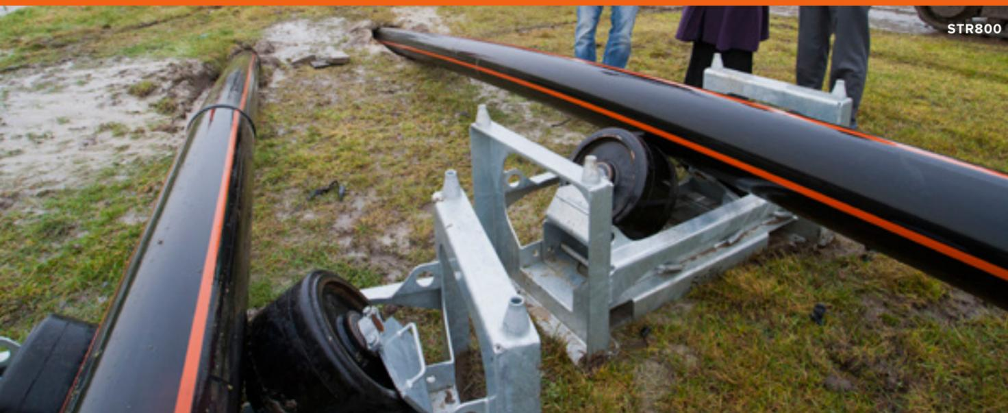
Rouleaux de tuyaux pour un diamètre de conduite allant jusqu'à 1 600 mm
