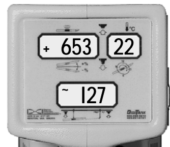
Mode de repérage montrant l'intensité du signal, la température de l'émetteur et la profondeur prédite
