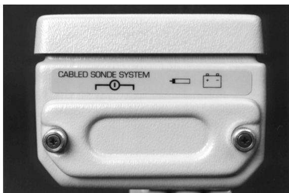
Étiquette indiquant que l'appareil de téléaffichage est prêt pour câble
