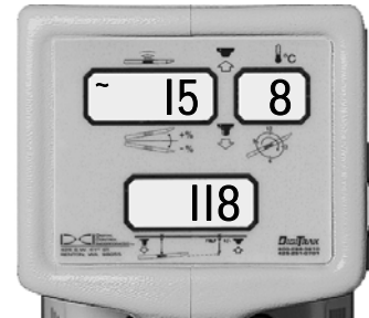
Mode de progrès montrant l'assiette longitudinale et latérale, la profondeur ou distance et le symbole de mise à jour
