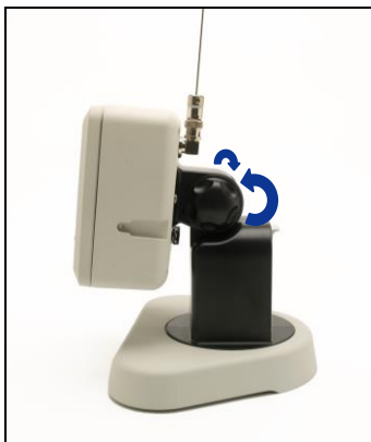
Loosen Display Knobs
