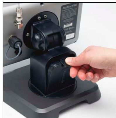
Installation de la batterie FSD
