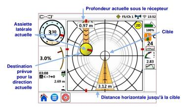
Orienter la bille d'indication de guidage jaune (destination prévue) vers la cible. Dans ce cas de figure, on estime que la tête de forage se trouve actuellement à 0.97 m sous le plan du récepteur et doit se déplacer de 3.12 m pour atteindre le point cible sous le récepteur.
