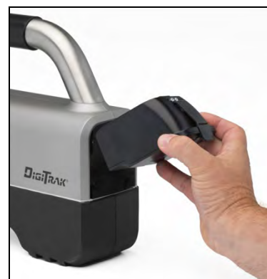
Dépose du bloc batterie
