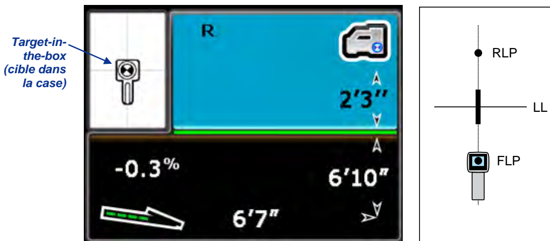
Écran mode relevé de profondeur du récepteur (sur FLP avec HAS activé)
