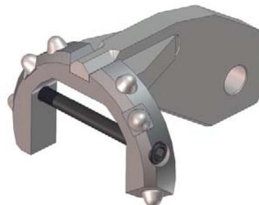
Le système breveté Eagle Eye 2 fait partie du système Melfred Borzall FastBack. Il est conçu pour permettre le tirage direct de petites conduites avec le trépan Eagle Claw. L'Eagle Eye 2 se fixe rapidement et en toute sécurité au trépan Eagle Claw, protège de l'usure pendant le tirage retour et maintient l'émerillon aligné avec l'ensemble de traction.
