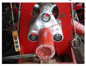
6. Placez la douille Inrock sur une clé dynamométrique de 1000 ft\*lbf (1355 Nm) ou sur la clé Inrock, puis sur l'écrou de fixation. Ne pas utiliser une clé de serrage à air comprimé, car on ne peut pourra pas mesurer le couple de serrage.
